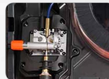
Les modèles Kempact 181/251 disposent d'un système de dévidage à 2 galets GT02.
