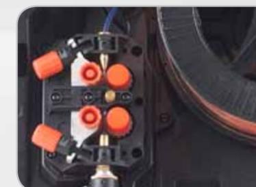
Les modèles Kempact 253/323 disposent d'un système de dévidage à 4 galets DuraTorque.
