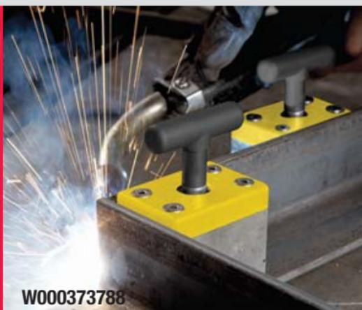
Réaliser rapidement des angles. Rapprocher les coins avec un blocage sur plusieurs côtés.
