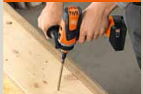
Même les vissages compliqués, tels que les vis à filetage complet 10x400 mm, sont possibles sans pré-perçage.
